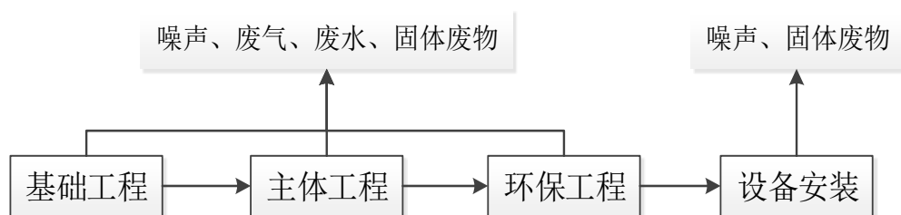
图2.3-1 本项目施工期工艺流程图
