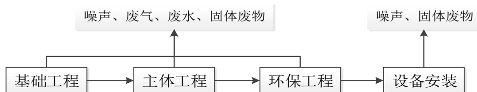
图2.3-1 本项目施工期工艺流程图
